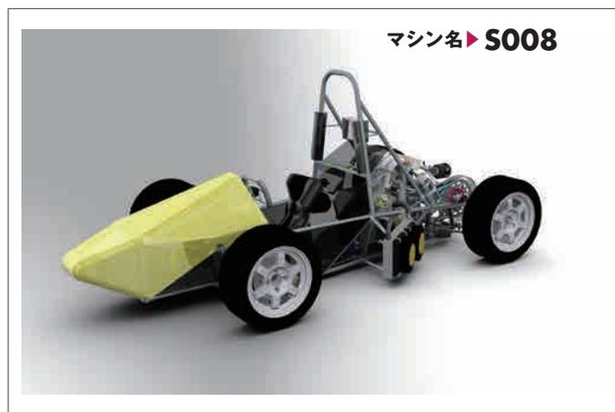
第9回大会出場車両「S008」は、開発コンセプトに「コーナリング性能の向上」を掲げ、軽量化・低重心化を念頭に置き車両の開発・設計を行い、マシンを仕上げました。今年度は震災の影響や設計ミス等が重なりシェイクダウンが遅れ、車両が全開で走行できるようになったのは大会直前、「ツインリンクもてぎ」での試走会でした。
