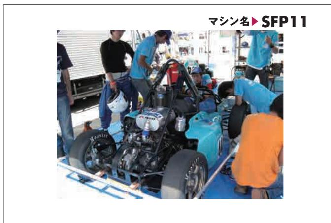
SFP11の車両コンセプトは「コーナー最速」です。年々テクニカルになるエコバの低速コーナーに重点をおいて設計製作を行ってきました。コーナーをより速く駆け抜けるために、車両の軽量化と昨年度車両の剛性の見直しを行いました。また車両の完成度を上げるため4月上旬にはシェイクダウンを行い、十分にドライバーが練習できる時間を設けました。
