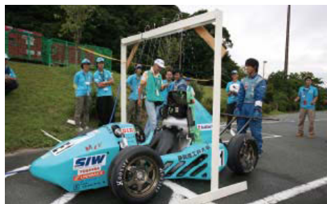
EV車のレインテスト。心配そうに見ていたが無事合格。実はこの装置、主催者の依頼で静岡理科大学により製作されたもの。
