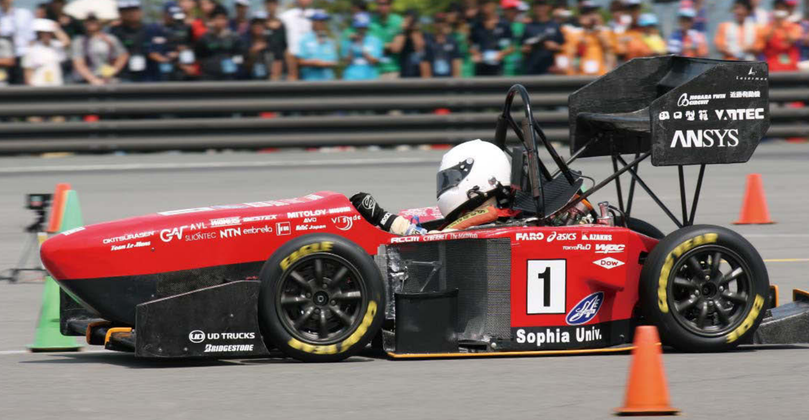
上智大学は世界の流れにも目を向け、ハイダウンフォース志向で車両を開発
