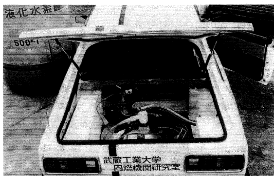
図18 武蔵5号のLH 2 タンクとポンプ駆動機構
