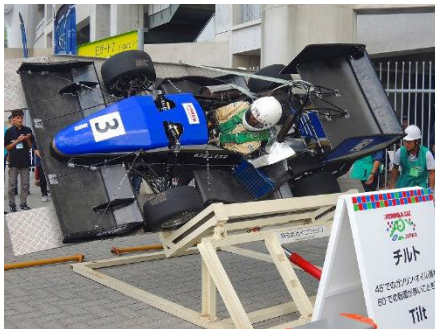
チルト検査 (傾斜時の燃料漏れ等の確認)
