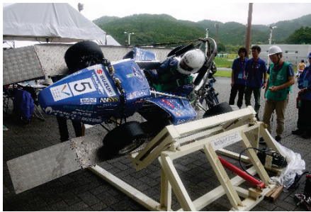
チルトテスト(燃料等の漏れ確認)
